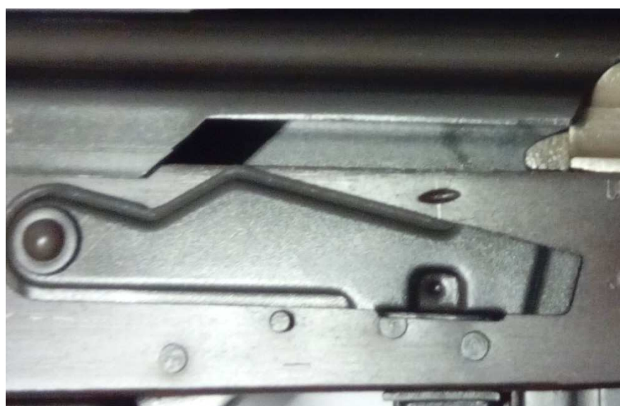
Zastava M-76 con la leva in posizione di Fuoco semiautomatico
