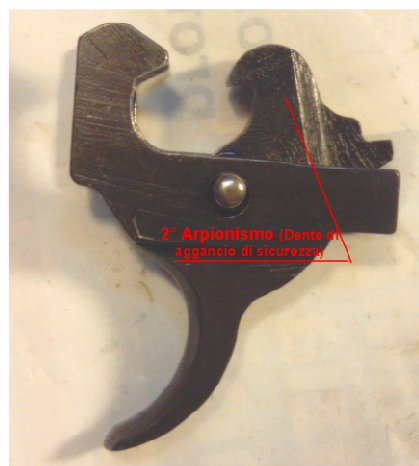
Gruppo di scatto della M-76: grilletto con dente di scatto e dente d’arresto (2° arpionismo)
