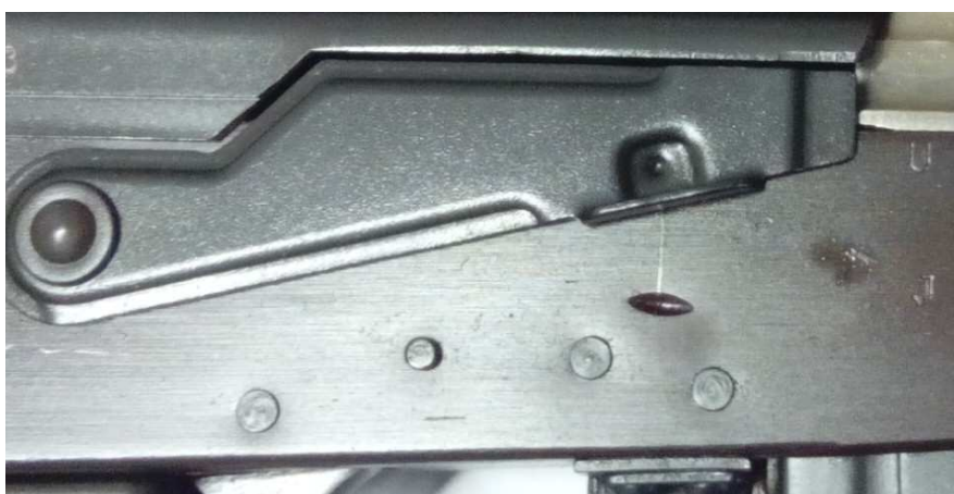
Zastava M-76 con la leva in posizione di sicura inserita
