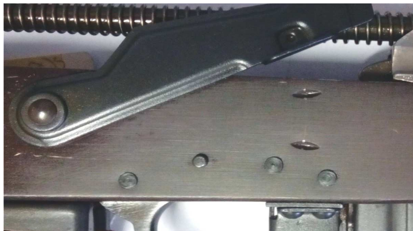
Zastava M-76 Semiautomatica – sono evidenti gli STOP : in alto per SICURA, in basso per TIRO SEMIAUTOMATICO
