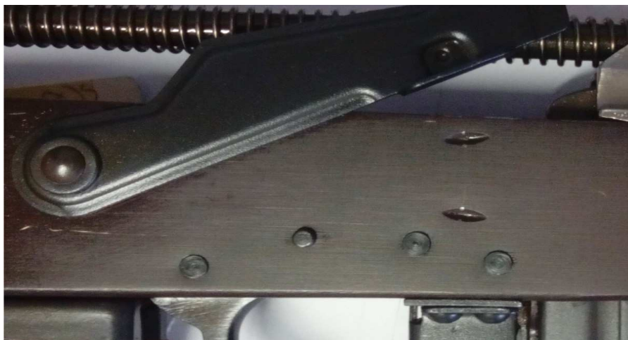
Zastava M-76 che presenta due incavi dove la leva Sicura-Fuoco si blocca
